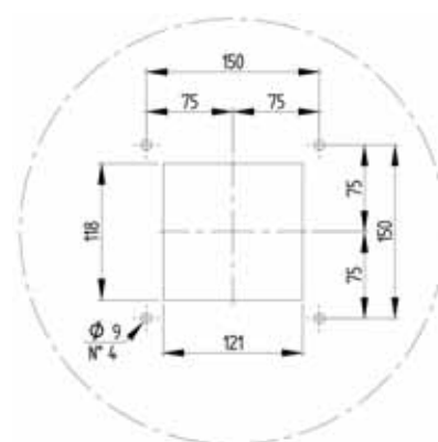
Εικ. 6b. Διαστάσεις ανοίγματος 'B-ECO 3
