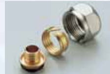
ΚΩΔ. 1436N Για σωλήνα PE-X / for PE-X pipe Προσρμογείς 3/4"x18 (Ευρωκώνος) Adapter for fittings with 3/4" x 18 (EUROCONUS) connection
